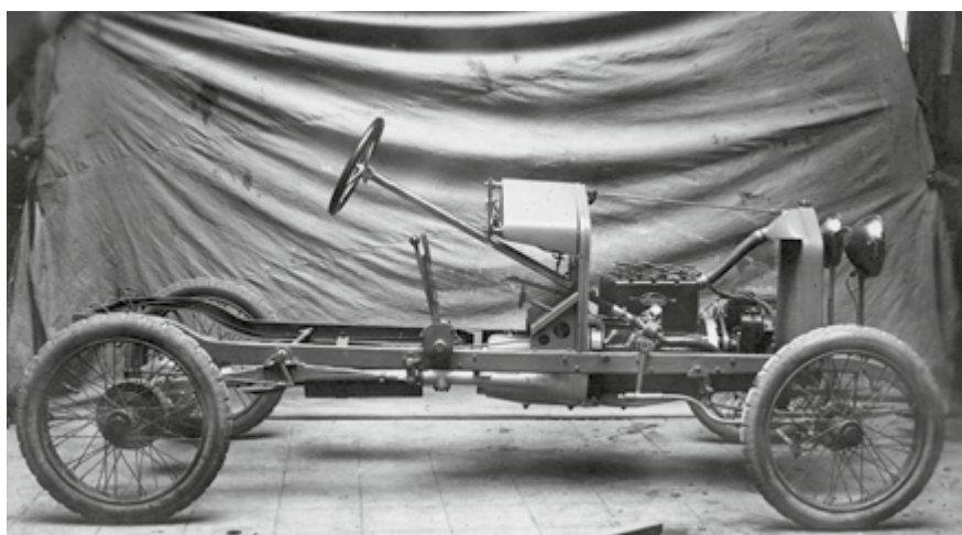
El lujoso coche de la foto es un Panhard Levassor que lleva las ruedas elásticas diseñadas por el ingeniero Pazos, rueda que vemos en la foto inferior junto al chasis de un América tipo B.
