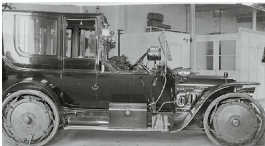
El lujoso coche de la foto es un Panhard Levassor que lleva las ruedas elásticas diseñadas por el ingeniero Pazos, rueda que vemos en la foto inferior junto al chasis de un América tipo B.
