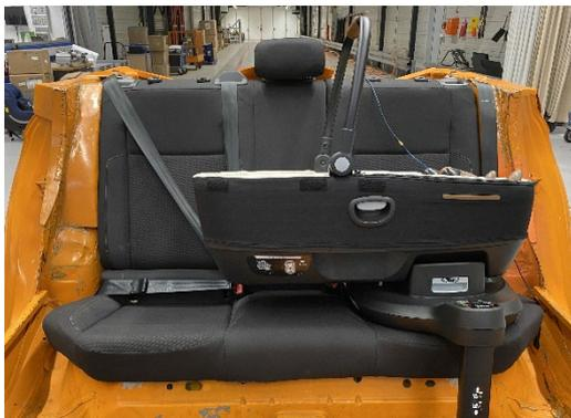
Figura 5: «Joie Calmi + i-Base Encore» montada en los asientos de atrás (© ADAC, FSI)
