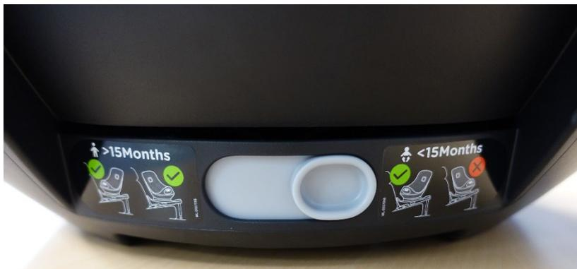
Figura 1: Interruptor deslizante en la Joie i-Harbour (© ÖAMTC)
