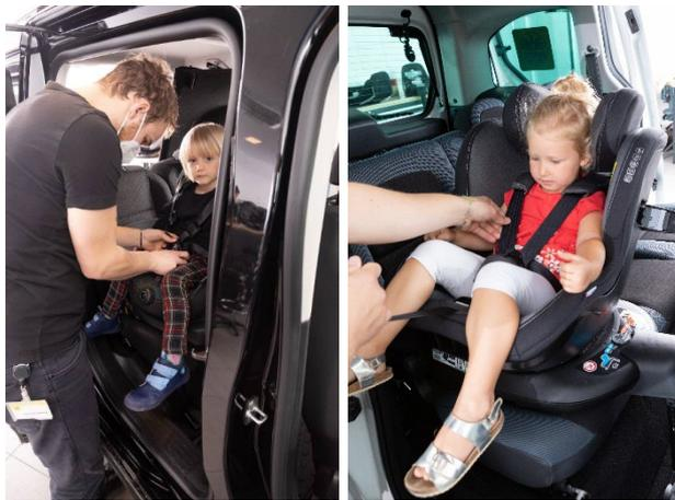
Figura 4: Las estructuras basculantes de las sillas facilitan la colocación y el abrochado (© ÖAMTC, Stephan Huger)
