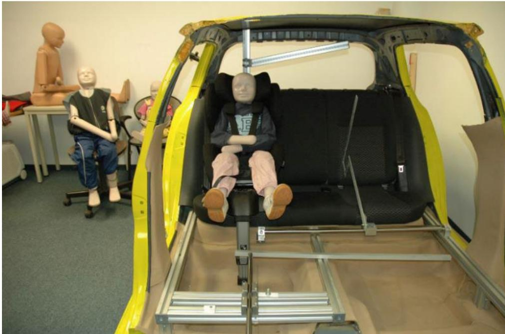
Figura 9: Preparación de la prueba de ergonomía (© ÖAMTC)
