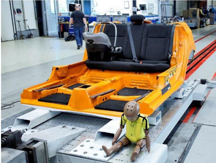
Figura 6: Preparación de la prueba de impacto frontal (© Ralph Wagner)
