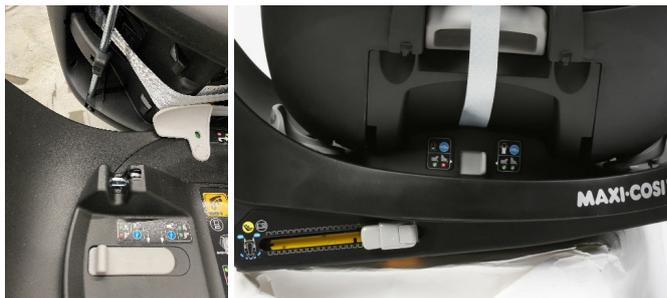
Figura 4: Interruptor deslizante en los dos modelos de silla Maxi-Cosi
