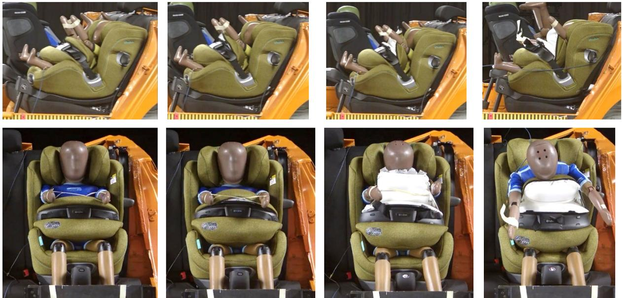
Figura 2: «Cybex Anoris T i-Size durante la prueba con el dummy Q1½ (fila superior de imágenes) y el dummy Q6 (fila inferior de imágenes)
