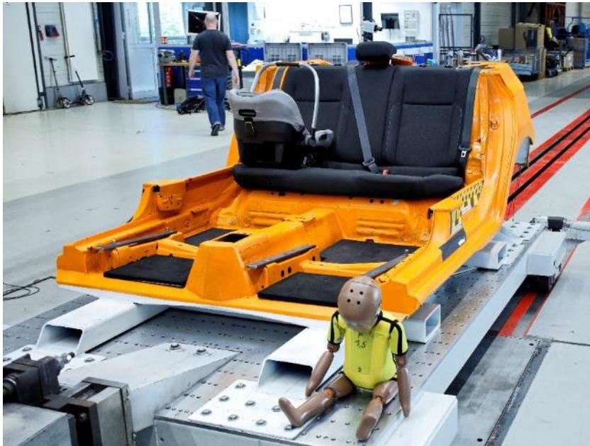
Figura 14: Preparación de la prueba de impacto frontal
