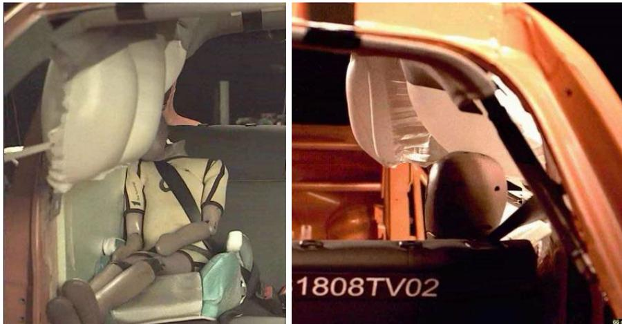
Figura 12: El airbag de la cabeza no llega lo suficientemente abajo como para proteger la cabeza del menor en caso de un impacto lateral
