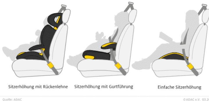
Figura 13: Tipos de asientos elevadores (asiento elevador sin respaldo, cojín elevador con guías para el cinturón, cojín elevador sin guías para el cinturón)
