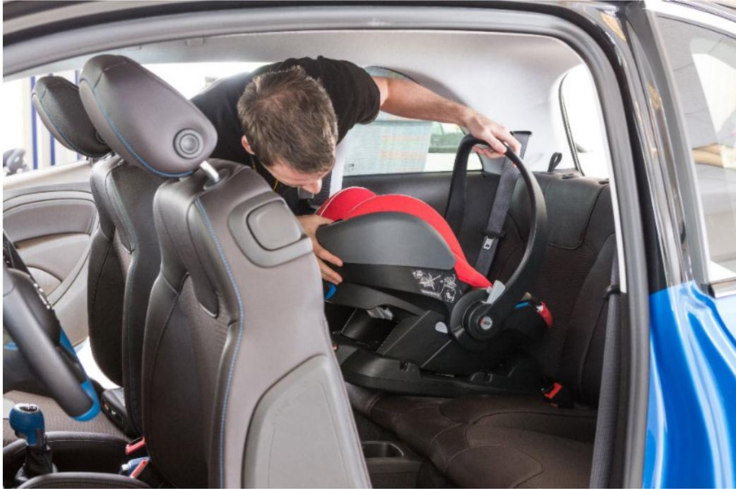
*Figura 16: Instalación de ensayo en un vehículo de tres puertas*
