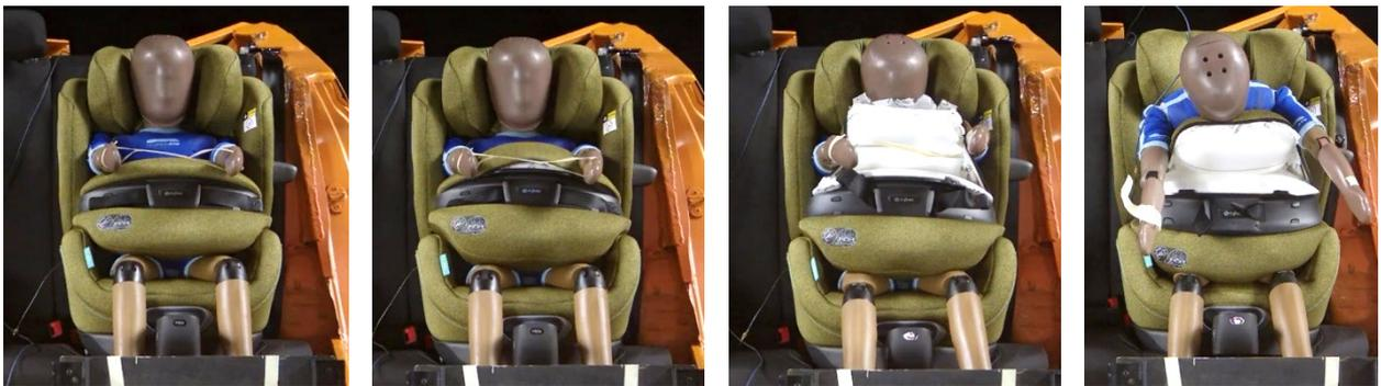
Figura 1: «Cybex Anoris T i-Size» en la prueba de colisión frontal
