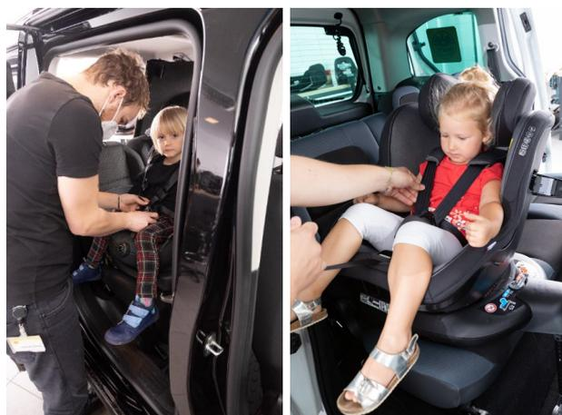
**Figura2:** *Los armazones giratorios de las sillas facilitan la elevación y el abrochado del niño (© ÖAMTC, Stephan Huger)*
