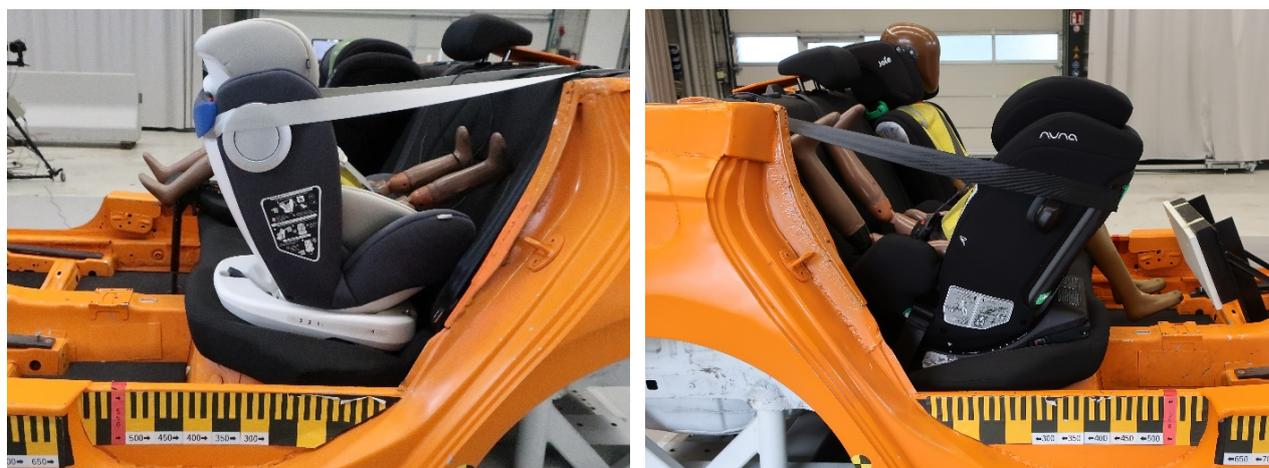
**Fotografía3:** *En el Murphy (916) de Lettas y el Tres LX de Nuna, el cinturón del vehículo y la fijación superior molestan a la hora de levantar al niño (© ADAC, FSI).*
