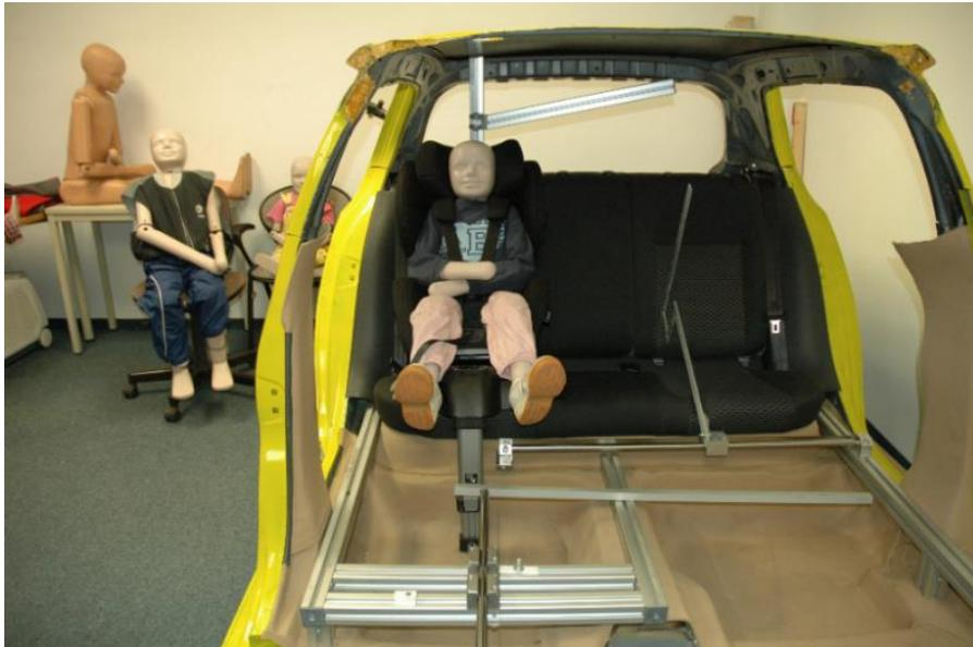
Imagen 9: Preparación de la prueba de ergonomía
