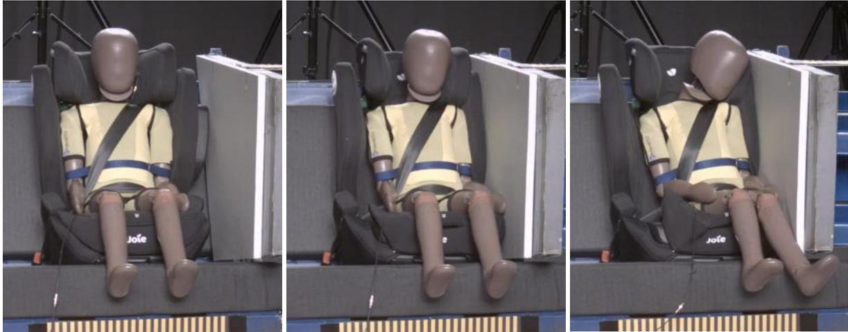
Imagen 12: Prueba de impacto lateral. Alza con respaldo
