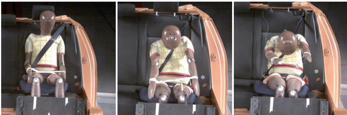
Imagen 10: Prueba de colisión frontal con alza sin respaldo. El cinturón abdominal permanece colocado sobre la cadera del maniquí
