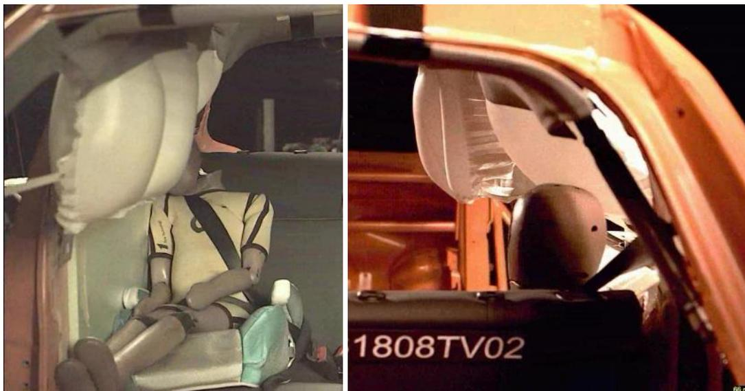
Imagen 11: Prueba de colisión lateral con airbag superior y maniquí infantil sentado en un alza
