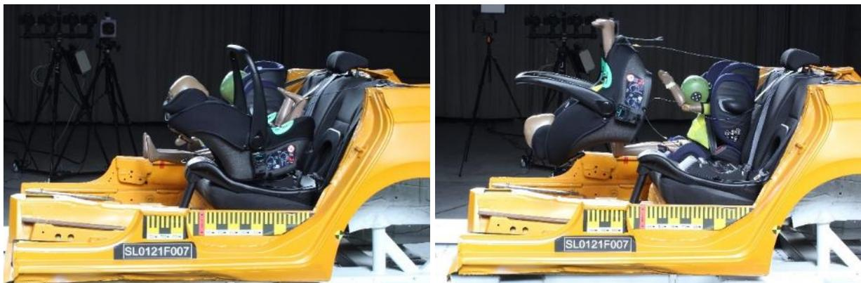
*Imagen 2: Chicco Kiros i-Size + Kiros i-Size Base en la prueba de colisión frontal con el maniquí Q1 ½*
