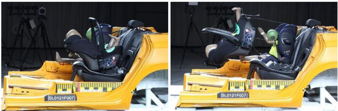
Imagen 1: Chicco Kiros i-Size + Kiros i-Size Base en la prueba de colisión frontal con el maniquí Q1 ½
