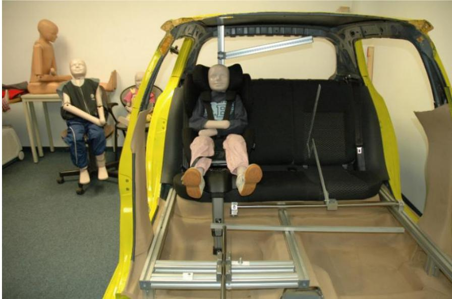
Imagen 17: Preparación de la prueba de ergonomía
