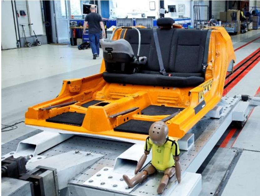
*Imagen 14: Preparación de una prueba de colisión frontal*
