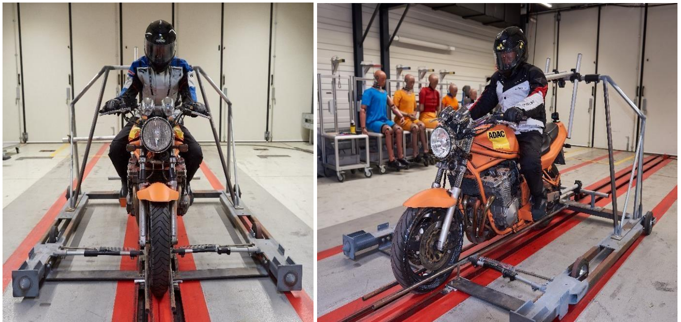
Figura 5: Trineo de deslizamiento
