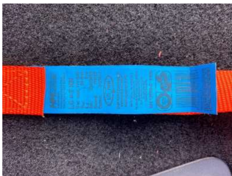
Utilice únicamente correas testadas según la norma EN 12195, y cuya etiqueta así lo indique
