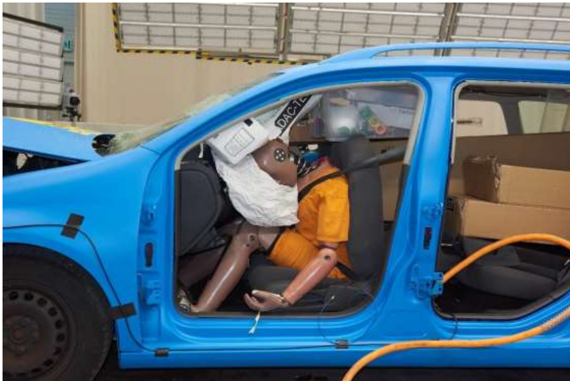
Choque con la carga sin sujetar: asientos desplazados hacia delante, zona de supervivencia dl conductor y acompañante comprometidas, y daños graves en cráneo.
