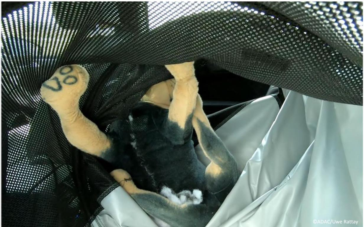
El perro está acostado en el Pet Tube sin sujeción. Tras las maniobras de esquiwa realizadas con el vehículo, el perro sale disparado con fuerza contra los revestimientos de las puertas. Al no existir opción de sujetar al animal dentro del tubo, no ofrece la protección suficiente.
