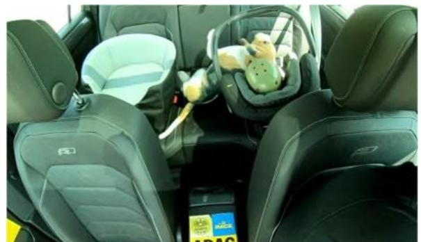
En la prueba, el muñeco de perro se colocó deliberadamente en la canasta sin estar sujeto por una correa para el pecho, con el objetivo de mostrar los efectos de esta falta de sujeción. El perro sale despedido de la canasta durante el ensayo de evasión y aterriza directamente en la silla de bebé situada al lado, por lo que la colisión puede causar lesiones graves al bebé.
