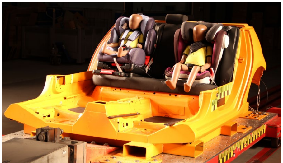
Imagen: Configuración del ensayo de impacto frontal
