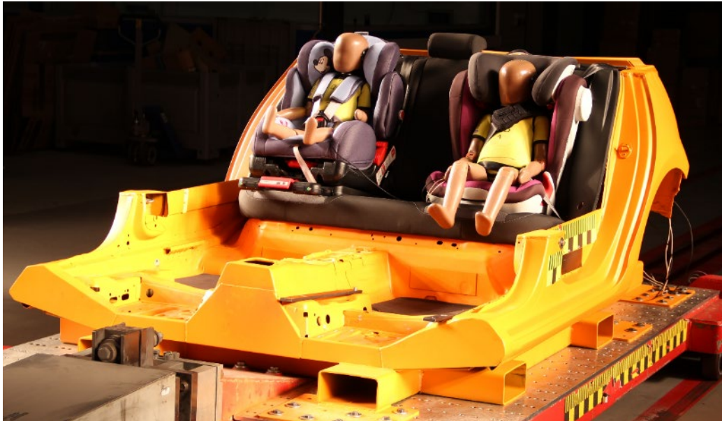
Ilustración 1: Configuración del ensayo de impacto frontal
