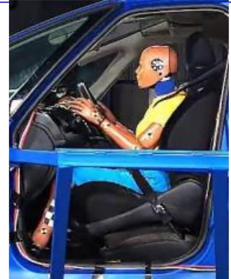
**60 ms** A los 22 milisegundos **comienza el hinchado del airbag** y la disminución de velocidad progresiva de la conductora.
