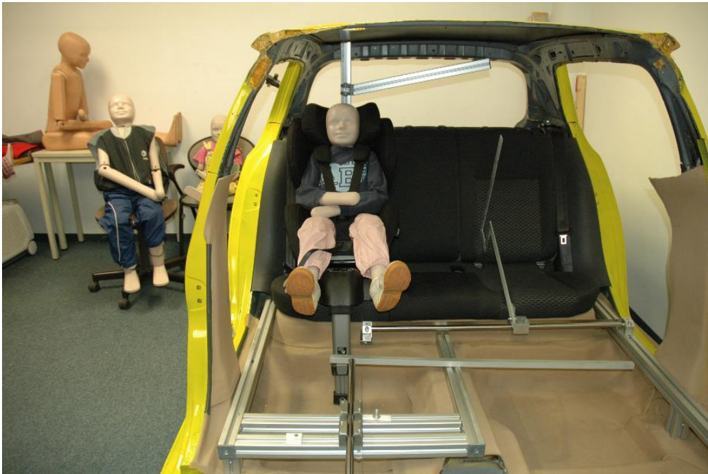
Ilustración 7: Diseño de la prueba para evaluar la ergonomía
