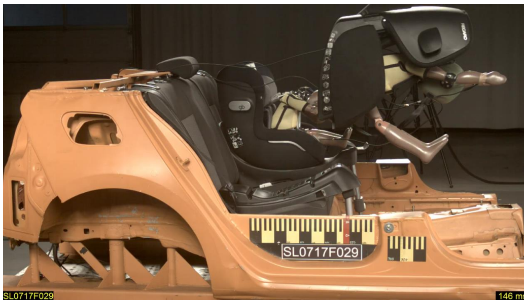
Ilustración 1: Recaro Optia y Base Smart Click en choque frontal
