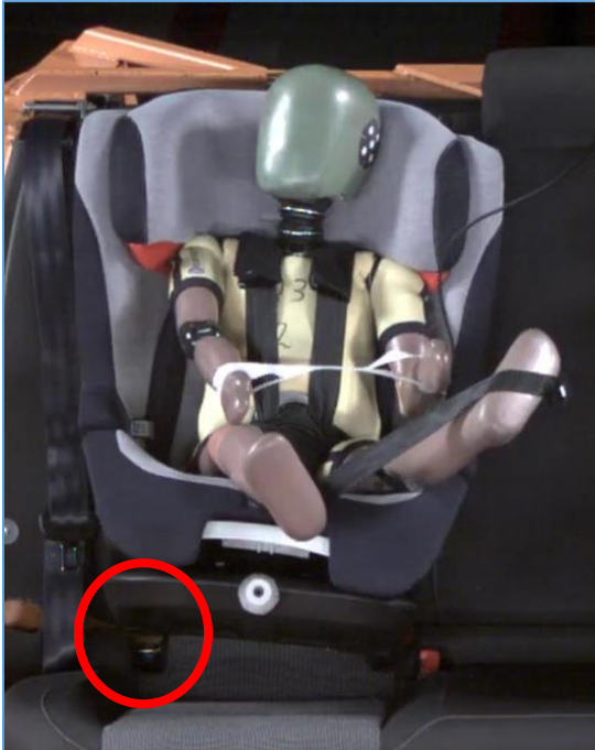
Ilustración 2: En el choque frontal con el Jané Grand se suelta un anclaje Isofix
