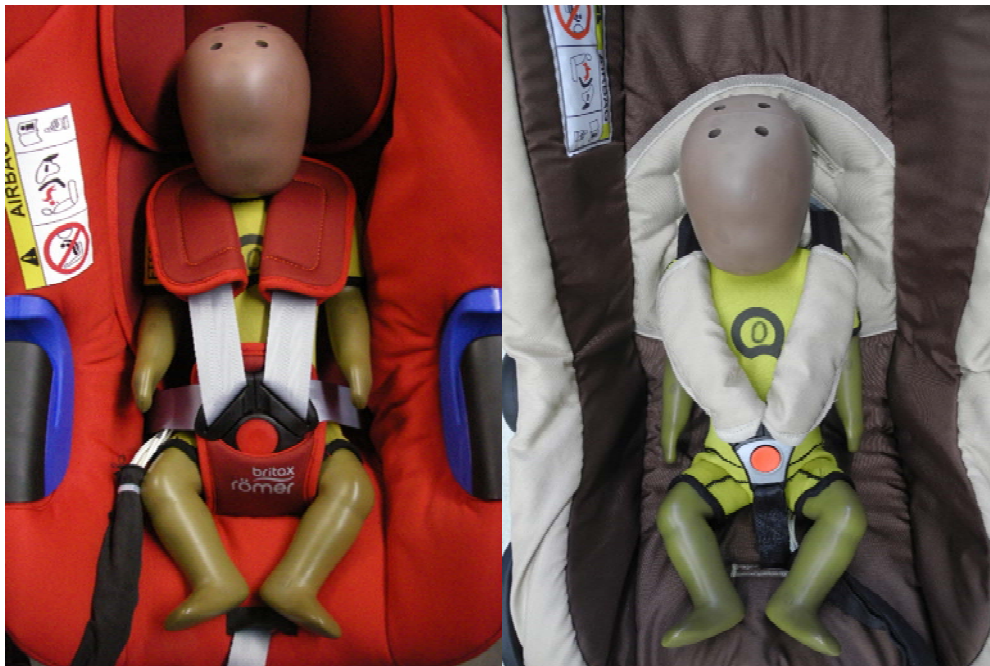
Figura 2:3 Arnés incorporado de la Britax Römer Baby Safe i-Size y la sillita de bebé Bergsteiger
