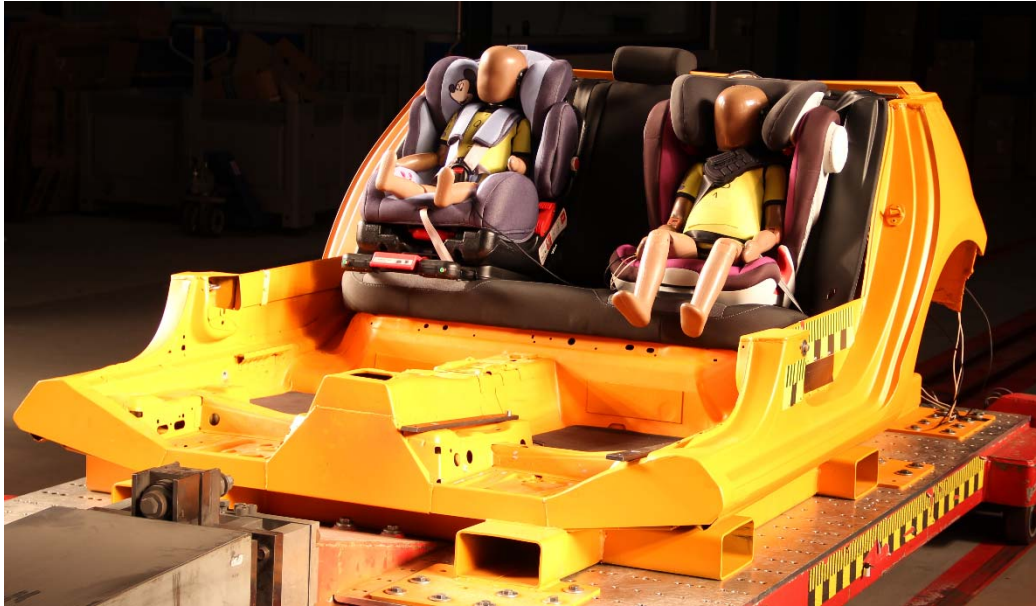
Figura 3: Configuración de la prueba de impacto frontal
