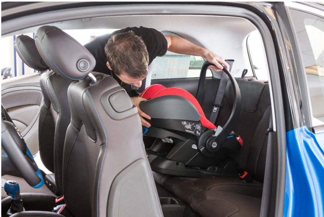
Figura 5: Prueba de instalación en un vehículo de 3 puertas
