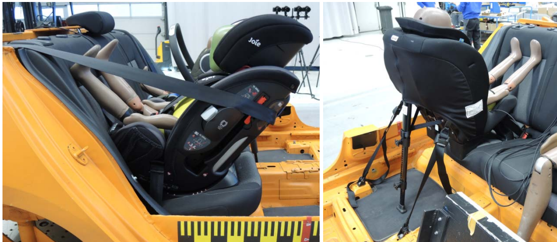
Figura 4:4 Joie Every Stage y Axkid Wolmax instalados con orientación hacia atrás
