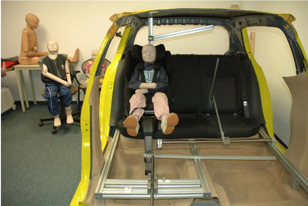
Figura 6: Configuración de la prueba de ergonomía
