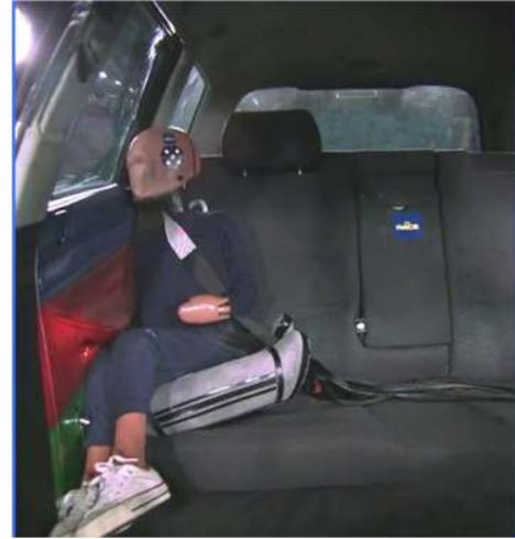
En ningún instante existe contacto de la cabeza y tronco con partes del vehículo. Las aceleraciones de cabeza, pecho y pelvis son prácticamente iguales, por lo que existe uniformidad del apoyo del cuerpo sobre el lateral de la silla y por consiguiente un reparto equilibrado de la carga que soporta
