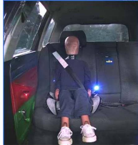
Situación del ocupante en plazas traseras antes del impacto. El ensayo representa un choque lateral en el que un vehículo golpea al que ocupa el niño, produciendo una aceleración lateral que provoca el desplazamiento de los pasajeros hacia el lado de impacto. No se simulan intrusiones dentro del habitáculo.
