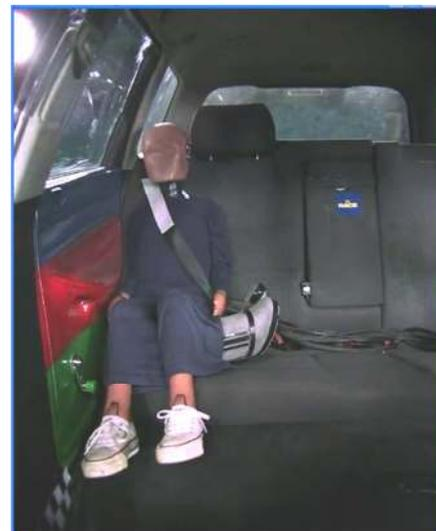
En el milisegundo 67 la cabeza, el tronco y la pelvis del niño continúan apoyados de manera uniforme sobre el lateral del asiento. No se observan flexiones laterales del cuello y el cinturón se mantiene sobre el hombro.
