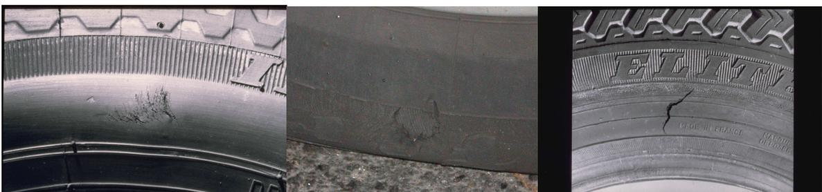
Daños en el montaje o desmontaje del neumático:
