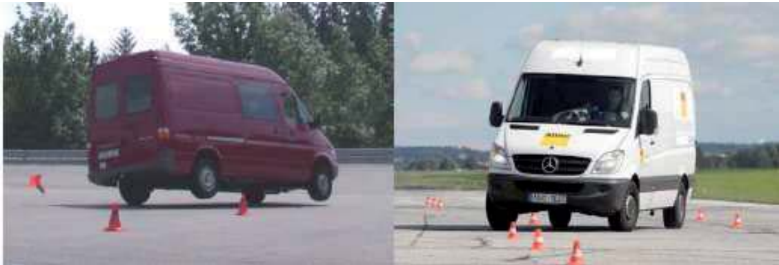
Prueba a 54 Km./h: sin y con ESP
