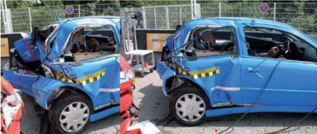
Prueba de choque por alcance: 60 Km./h
