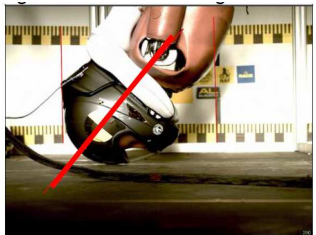
Figura 3: Comparación del casco con y sin airbag.
