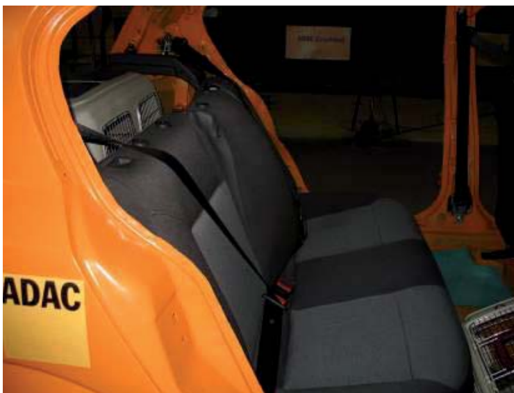
Figura 25: La deformación posterior al choque muestra la alta carga ejercida sobre el respaldo trasero.
