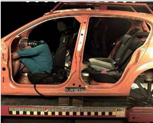
Figura 18: 100 ms — El arnés del perro retiene a la mascota sólo después de que ésta se haya golpeado contra el respaldo del asiento del conductor y lo haya deformado.
