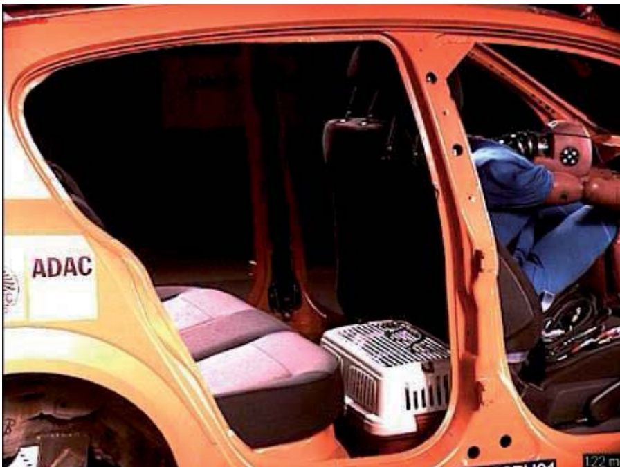
Figura 23: Buena retención del transportín y distribución uniforme de la carga.
