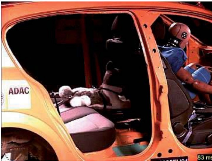
Figura 12: 83 ms — Cuando el maniquí de perro se desplaza hacia delante, el mosquetón no puede resistir la carga y se rompe.
