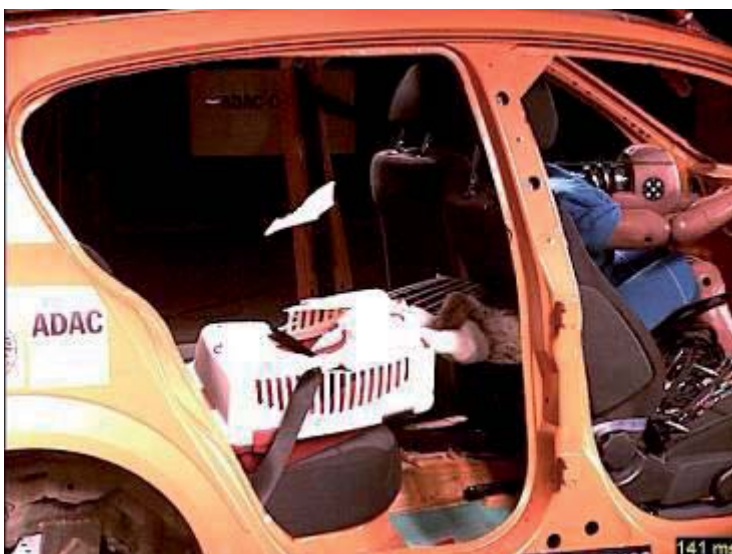
Figura 22: 140 ms — El maniquí hace que la portezuela se abra de golpe antes de golpearse casi a toda velocidad contra la parte posterior del respaldo del pasajero delantero.
