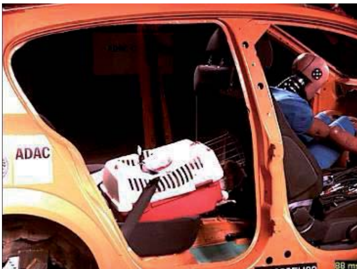
Figura 21: 90 ms — Los puntos de anclaje del transportín se revientan cuando el maniquí de gato fuerza la apertura de la portezuela.
