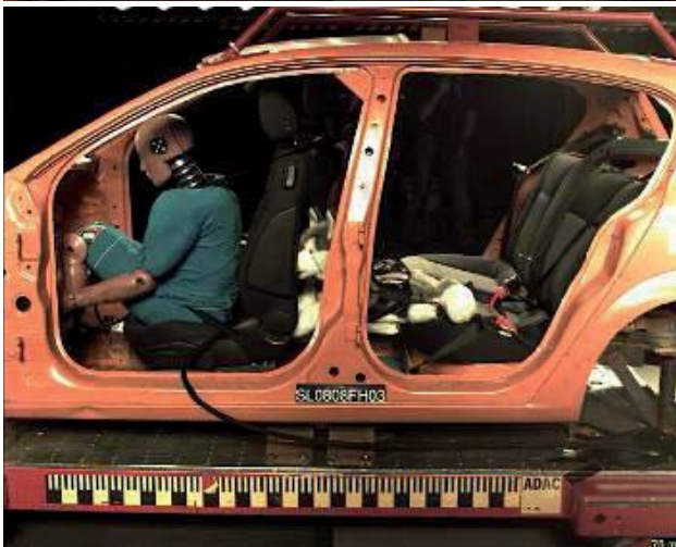
Figura 17: 75 ms — Después del impacto, el perro es lanzado hacia delante. La carga hace que las abrazaderas del cinturón se desvíen hacia el centro y se afloje el cinturón de seguridad del asiento.
