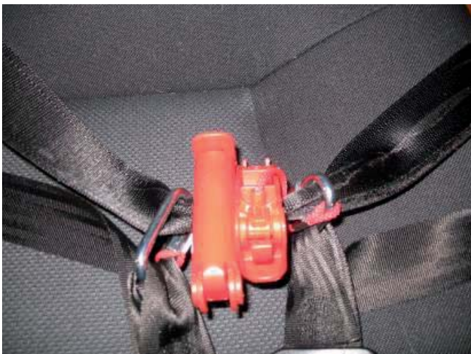
Figura 15: Sometidas a la carga, las abrazaderas se desvían hacia el centro de la cinta inferior del cinturón de seguridad, provocando un aflojamiento considerable del cinturón.
