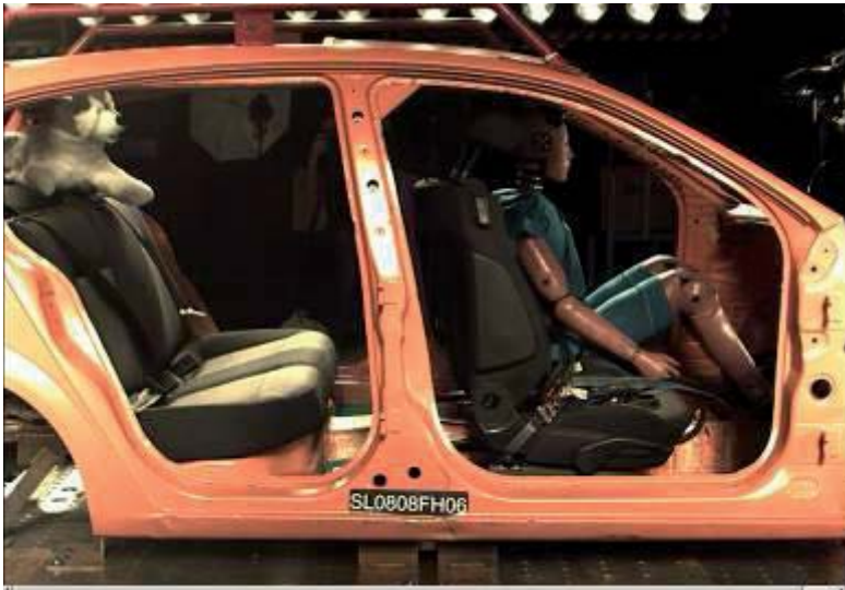
Figura 7: 0 ms — El maniquí de perro está en su posición original sobre la bandeja de la luneta trasera del turismo.
