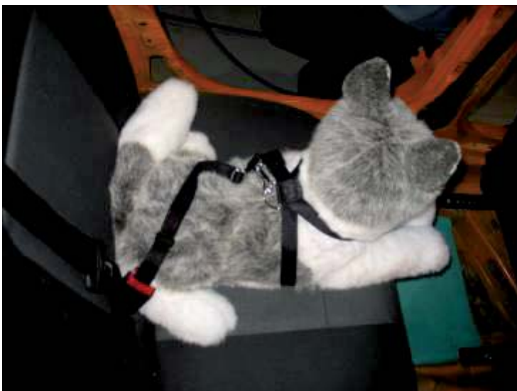
Figura 4: Arnés para perro con un solo enganche a la hebilla del cinturón de seguridad.
