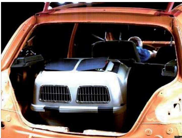
Figura 24: 125 ms — Después del impacto, el transportín es empujado contra el respaldo delantero.
