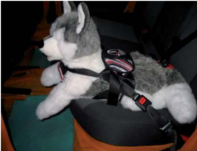
Figura 14: Se utilizan mosquetones y abrazaderas para sujetar el arnés del perro a cada lado.
