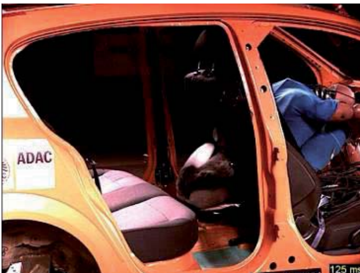
Figura 13: 125 ms — El maniquí de perro se da un topetazo contra el respaldo del asiento del conductor, causando una deformación extrema.
