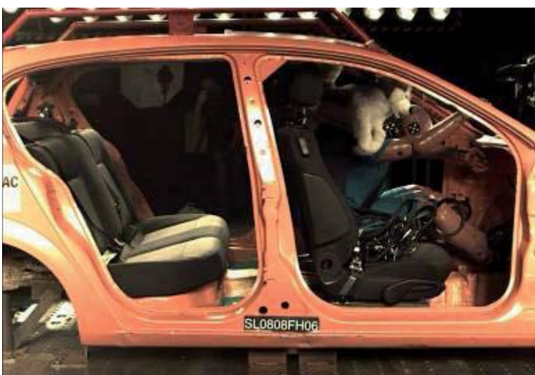
Figura 9: 150 ms — El perro deforma intensamente los respaldos y golpea la cabeza y la nuca del conductor.
