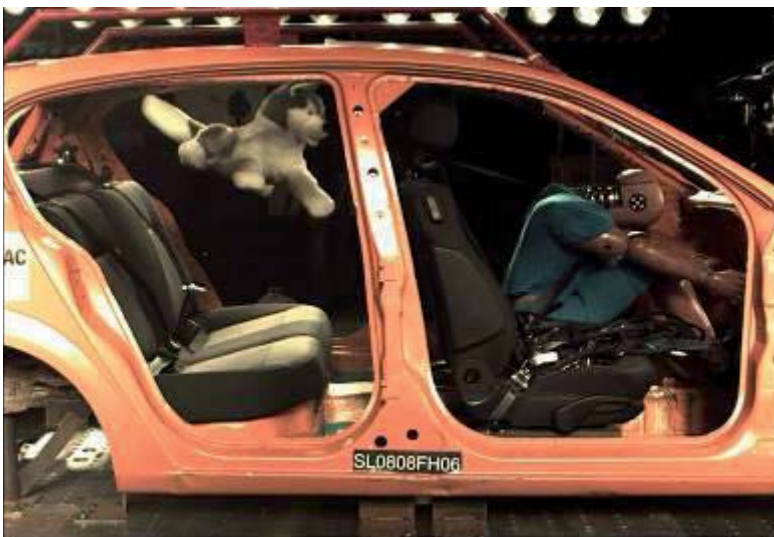
Figura 8: 50 ms — El maniquí de perro, sin retención, es lanzado a través de la cabina.
