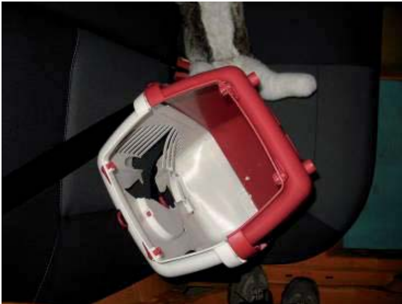
Figura 19: La portezuela del transportín se desencaja de sus goznes y quedan destrozados los puntos de sujeción del cinturón.
