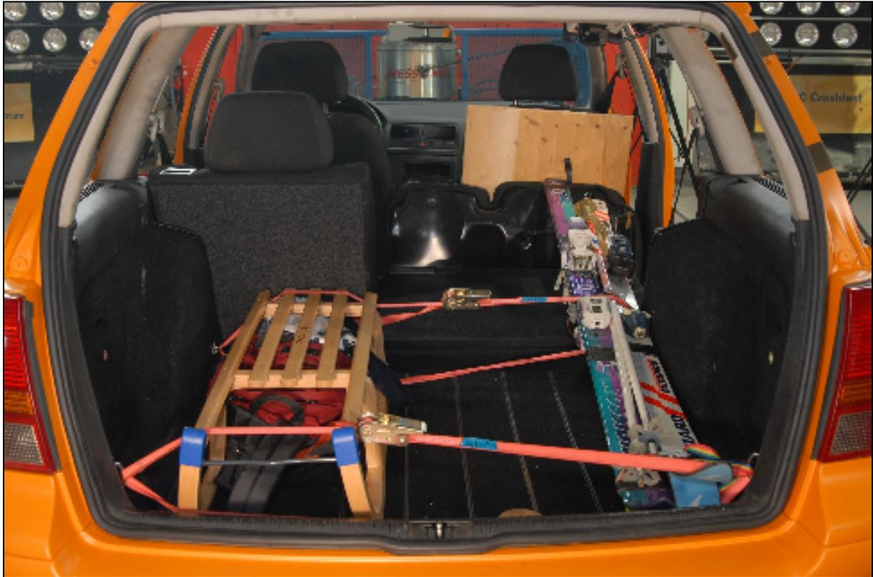
Figura 5: Carga asegurada correctamente.
