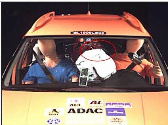
Una pieza del equipaje rompe el espejo retrovisor y rompe el parabrisas.
