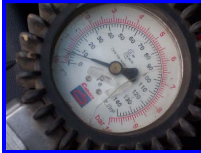
Daños en la esfera
