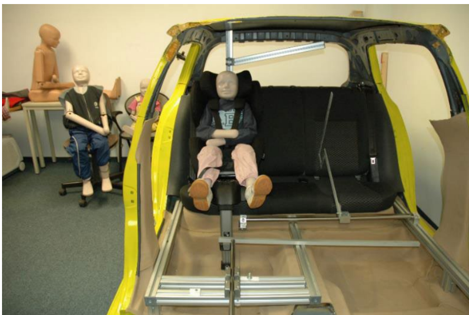
Imagen 8: Preparación de la prueba de ergonomía (© ÖAMTC)
