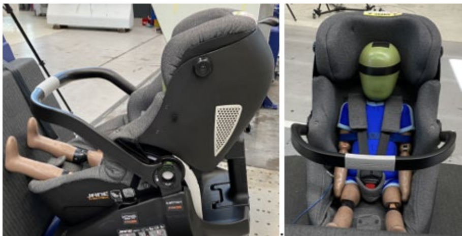
Imagen 4: Voluminosas almohadillas laterales de la Jané iMatrix (© ADAC, FSI)
