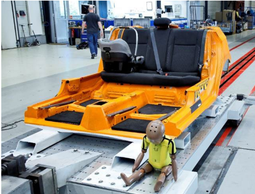
Imagen 5: Preparación de una prueba de colisión frontal (© Ralph Wagner)
