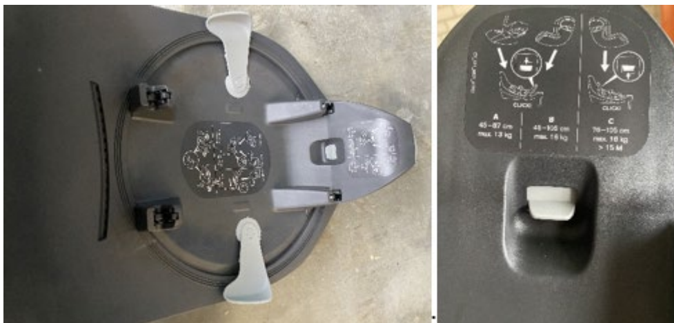
Imagen 1: Botón deslizante del modelo Cybex Base Z2 (© ADAC, FSI)
