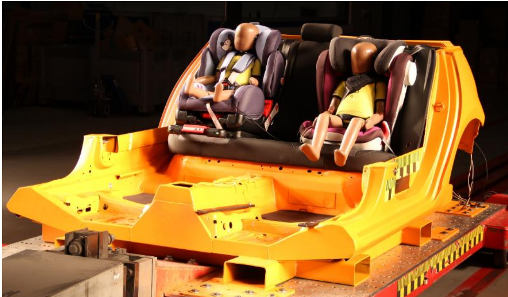
Ilustración 15: Configuración del ensayo de impacto frontal
