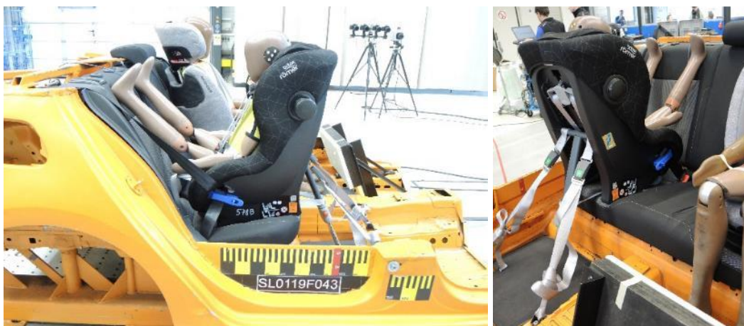
Ilustración 11: Modelo Britax Römer Max-Way Plus montado en el simulador de ensayo
