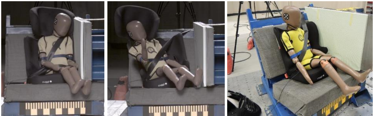
Ilustración 8: Modelo Cuggl Chaffinch durante y después del ensayo de impacto lateral
