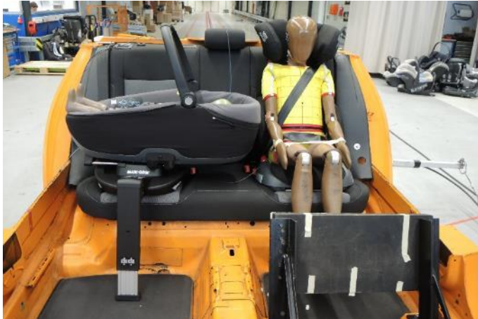
Ilustración 14: Maxi-Cosi Jade instalado en la parte trasera del coche (izquierda).
