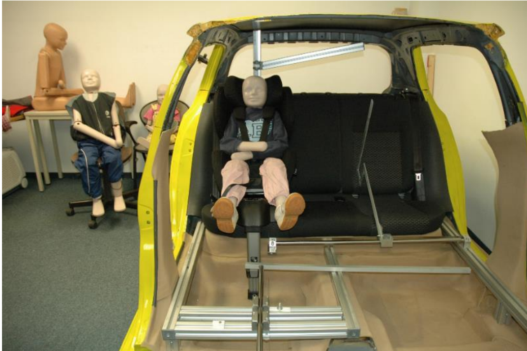
Ilustración 18: Configuración del ensayo de ergonomía
