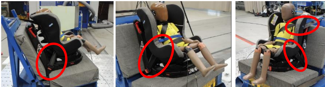
Ilustración 12: Modelo Giordani Galaxy 012 montado en el simulador de ensayo
