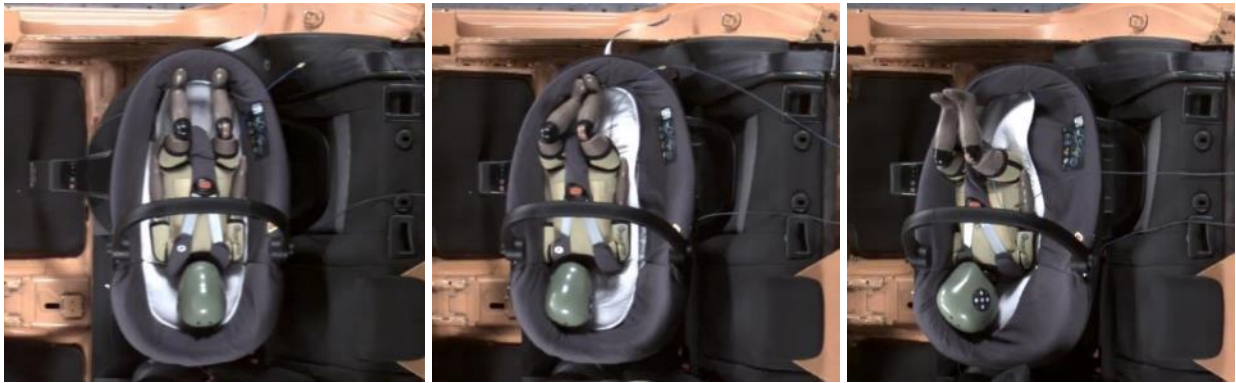
Ilustración 4: Bébé Confort Jade en el ensayo de impacto frontal con un maniquí Q1.
