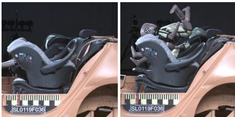
Ilustración 6: Chicco Oasis i-Size Bebecare + i-Size Base en un ensayo de impacto frontal con el maniquí Q1 ½
