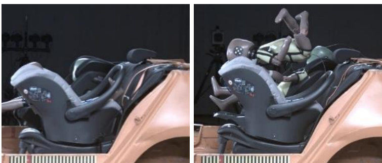
Ilustración 2: Modelo Chicco Oasys i-Size Bebecare + i-Size Base en el ensayo de impacto frontal con maniquí Q1 ½
