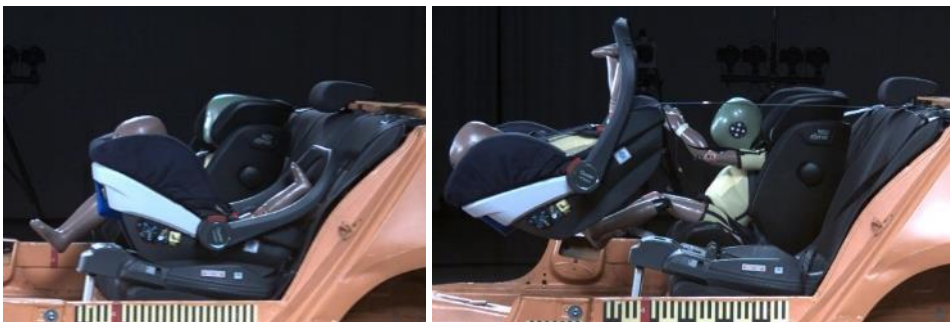
Ilustración 1: Modelo Babystyle Oyster Carapace Infant + Duofix i-Size Base en el ensayo de impacto frontal con el maniquí Q1 ½ .
