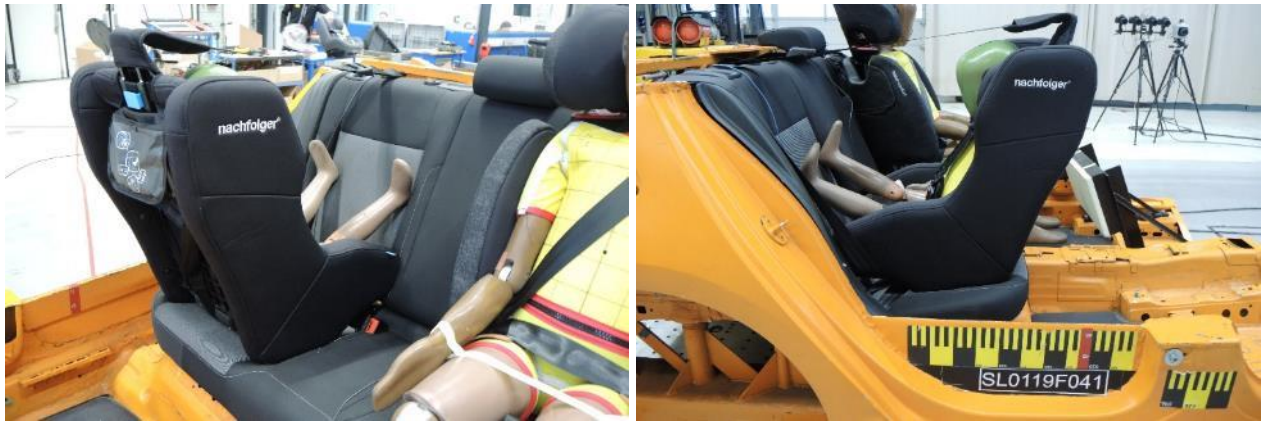
Ilustración 10: Nachfolger Hy5.1 TT instalado en el asiento trasero
