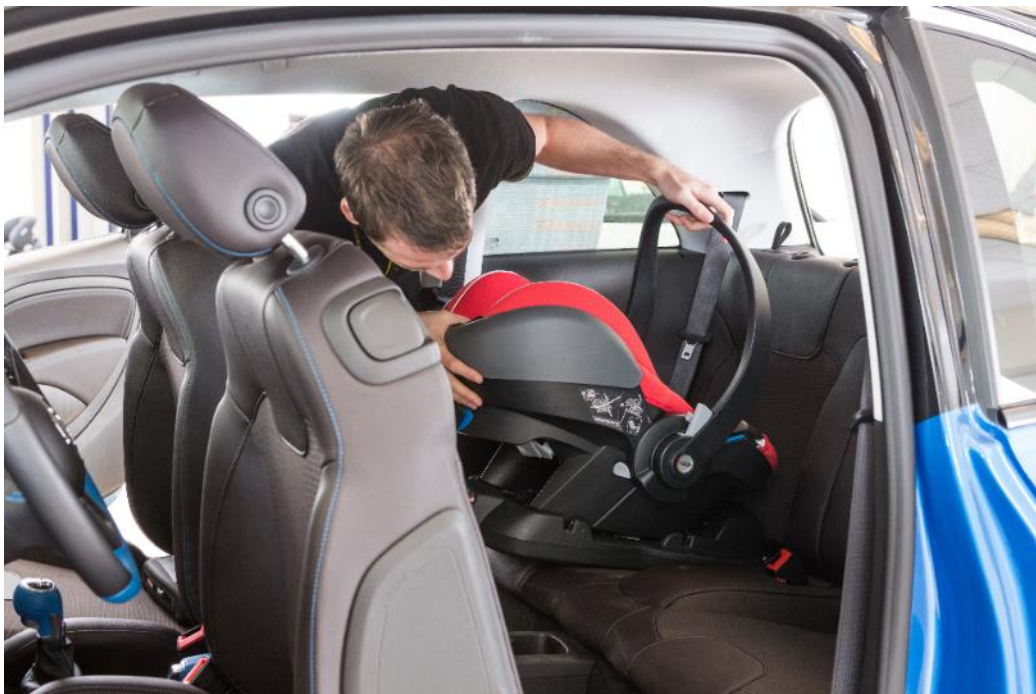
Ilustración 17: Instalación en un vehículo de tres puertas
