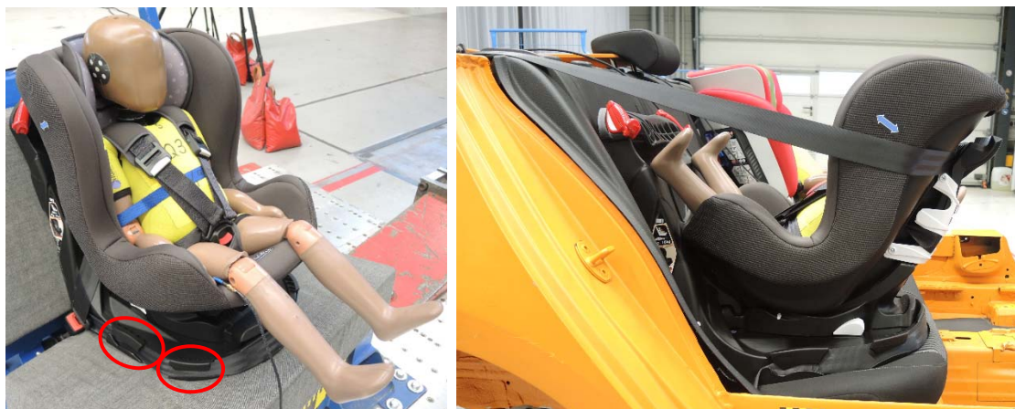
Imagen 4: Guía de los cinturones superior y abdominal del modelo Nania Revo
