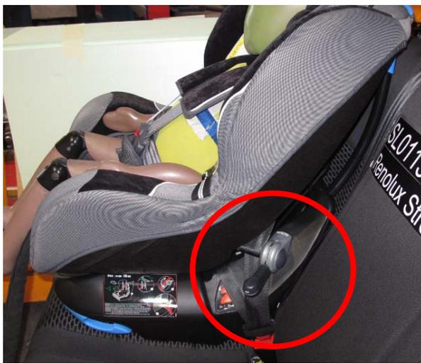
*Imagen 5: Mecanismo de tensión en el modelo Renolux Stream*
