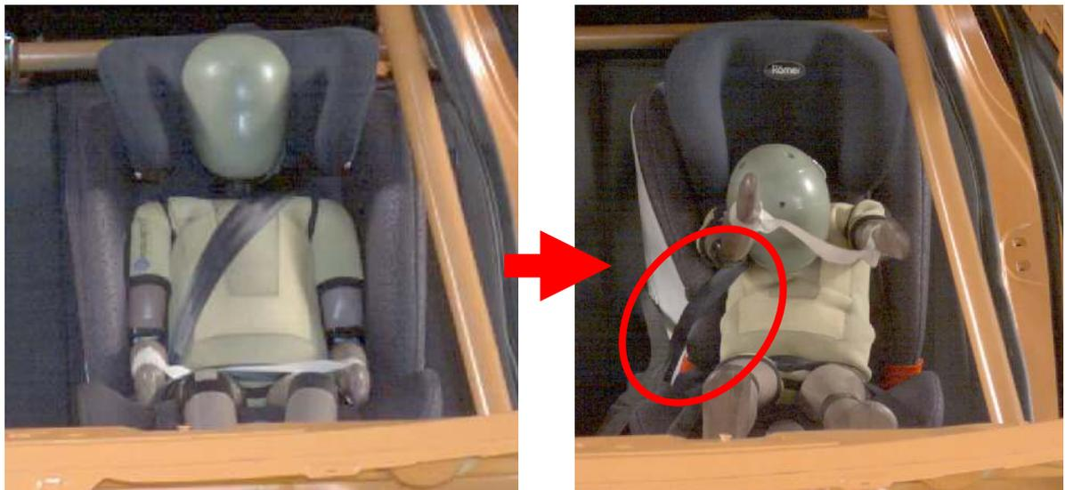
*Figura 2: Durante el ensayo del modelo Britax/Römer Xtensafix, el cinturón superior se escapa de la guía inferior y se incrusta en la cabeza y el cuello del maniquí*
