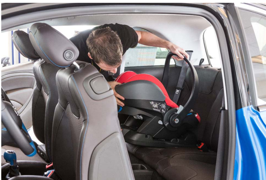
Figura 5: Prueba de instalación en un vehículo de tres puertas
