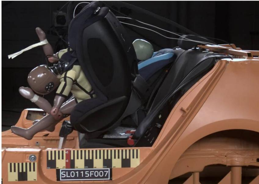
*Ilustración 1: En caso de impacto frontal, la Hauck Varioguard se separa de la base asegurada con el cinturón.*
