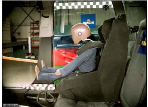
Desde el mseg 46 hasta el 74 se produce la deformación del suelo del vehículo en la zona de fijación de la pata. En ese intervalo de tiempo se produce la máxima aceleración de la cabeza (42.7 g en el ms 74) y del pecho (36.1 g en el mseg 67) del ocupante en dirección vertical. El movimiento de cabeza y pecho del dummy es más suave.
