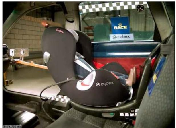
Desde el mseg 46 hasta el 74 se produce la deformación del suelo del vehículo en la zona de fijación de la pata. En ese intervalo de tiempo se produce la máxima aceleración de la cabeza (42.7 g en el ms 74) y del pecho (36.1 g en el mseg 67) del ocupante en dirección vertical. La deformación del suelo del vehículo y de la espuma del asiento afecta a la velocidad de movimiento de la silla y del ocupante.
