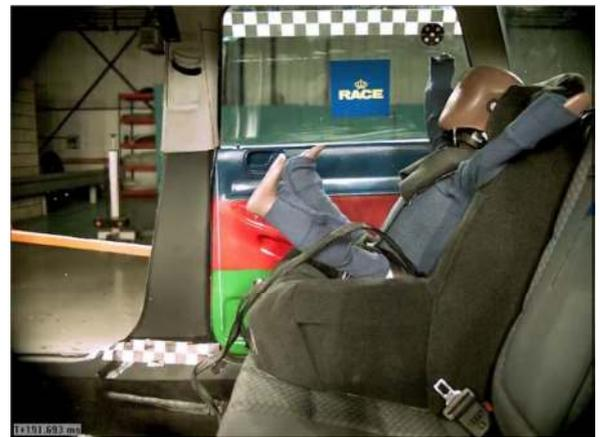
Desde el instante anterior hasta el mseg 191 se produce el retroceso del ocupante y de la sillita hacia la parte trasera del vehículo. En ese instante se produce un golpeo de la cabeza del dummy contra la sillita.
