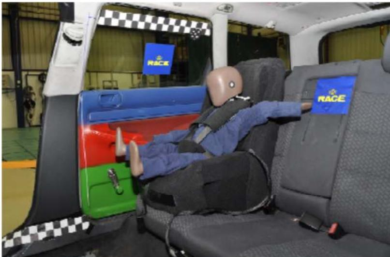
**El ocupante de 18 meses finaliza en la posición de la imagen. La silla permanece anclada al vehículo y el ocupante termina dentro de la misma. El maniquí de 1 1/2 años finaliza dentro del sistema de retención, el cual permanece anclado al vehículo tras el impacto.**
