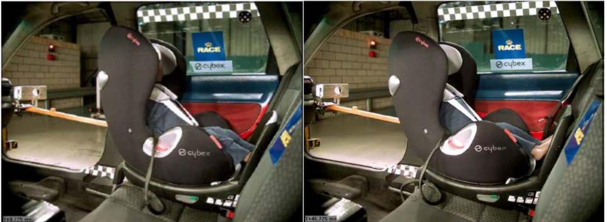
Situación del ocupante en plazas traseras antes del impacto. El ensayo representa un choque frontal de 2 vehículos a 64km/h con un solapamiento entre ellos del 40% por el lado del conductor.
