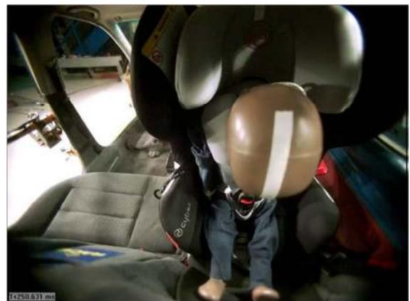
El conjunto sistema de retención-ocupante, comienza la fase de retroceso hacia la parte trasera del vehículo. Los niveles de aceleración medidos durante el retroceso no son importantes, a pesar del importante movimiento de la silla durante esta fase. Aún así sigue sin haber riesgo de eyección del ocupante.
