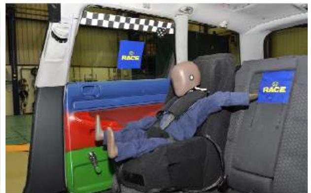
Tras el impacto, la silla permanece anclada al vehículo y el ocupante termina dentro de la misma en la posición de la imagen.
