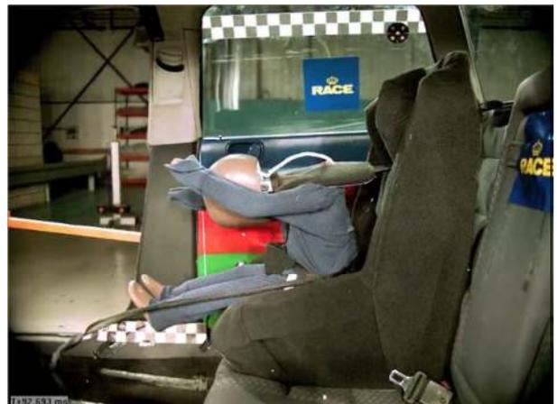
A los 92 ms, el ocupante permanece completamente dentro del sistema de retención hasta el instante de máximo desplazamiento del mismo. Los niveles de deceleración medidos en el ocupante van disminuyendo y no se ha producido riesgo de eyección del niño hacia el exterior.
