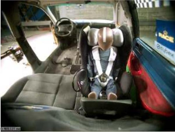
El conjunto sistema de retención-ocupante, comienza la fase de retroceso hacia la parte trasera del vehículo. Los niveles de aceleración medidos durante el retroceso no son importantes, a pesar del importante movimiento de la silla durante esta fase. Aún así sigue sin haber riesgo de eyección del ocupante. Posteriormente, el sistema de retención junto con el ocupante vuelven a una posición cercana a la inicial.
