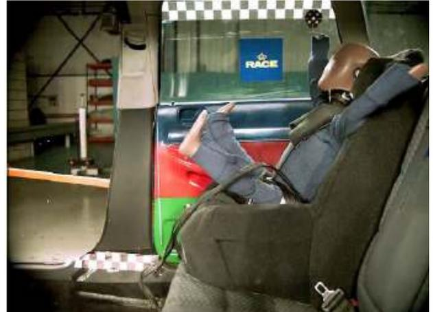
Desde el instante anterior hasta el mseg 191 se produce el retroceso del ocupante y de la sillita hacia la parte trasera del vehículo. En ese instante se produce un golpeo de la cabeza del dummy contra la sillita.
