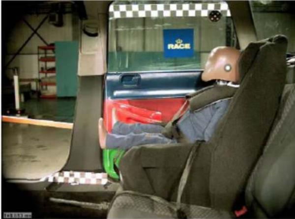
Situación del ocupante en plazas traseras antes del impacto. El ensayo representa un choque frontal de 2 vehículos a 64km/h con un solapamiento entre ellos del 40% por el lado del conductor.
