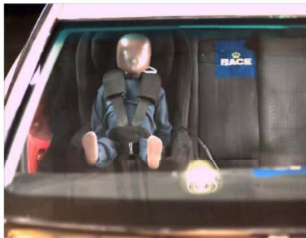
Situación del ocupante en plazas traseras antes del impacto. El ensayo representa un choque frontal de 2 vehículos a 64km/h con un solapamiento entre ellos del 40% por el lado del conductor.
