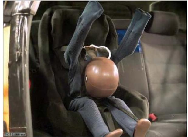
A los 112 milisegundos se produce la máxima rotación de la cabeza del dummy. La posición que adopta el ocupante corresponde con una gran flexión del cuello.
