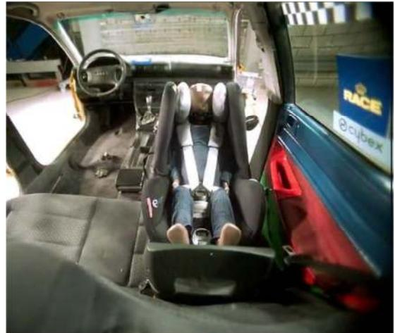
El ocupante permanece completamente dentro del sistema de retención hasta el instante de máximo desplazamiento del mismo. Los niveles de deceleración medidos en el ocupante van disminuyendo y no se ha producido riesgo de eyección del niño hacia el exterior.
