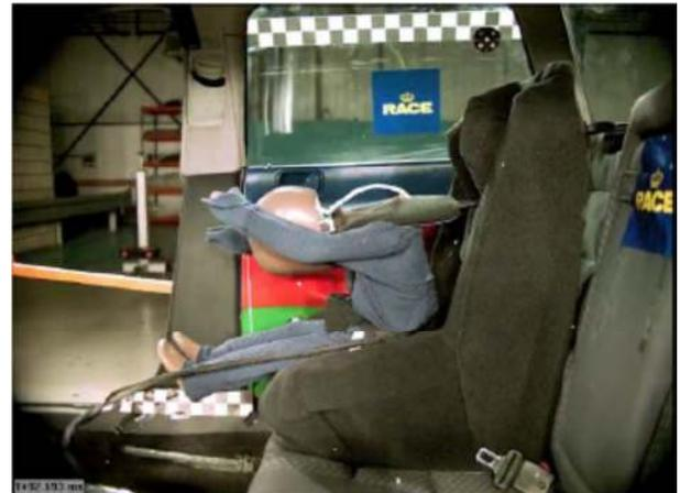
A los 92 mseg aproximadamente la cabeza alcanza su desplazamiento máximo sin superar el máximo avance admisible por lo que se encuentra protegido frente a cualquier impacto contra elementos del interior del habitáculo. La sillita continúa correctamente sujeta a la carrocería.
