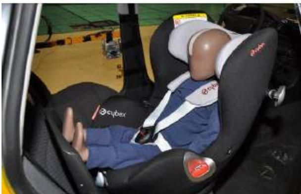
El maniquí de año y medio finaliza dentro del sistema de retención, el cual permanece anclado al vehículo tras el impacto, correctamente sentado.
