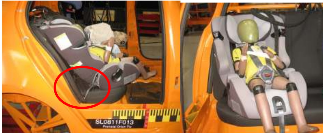
Figura 2: Posición del SRI Prenatal Orion Fix después del choque frontal.
