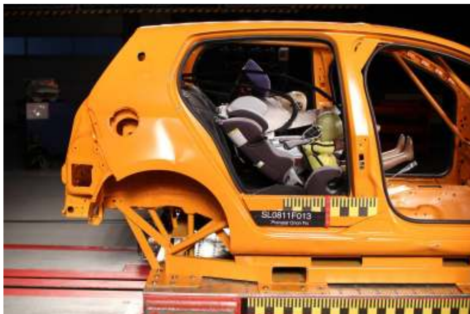
Figura 1: Comportamiento del Prenatal Orion Fix en el choque frontal.
