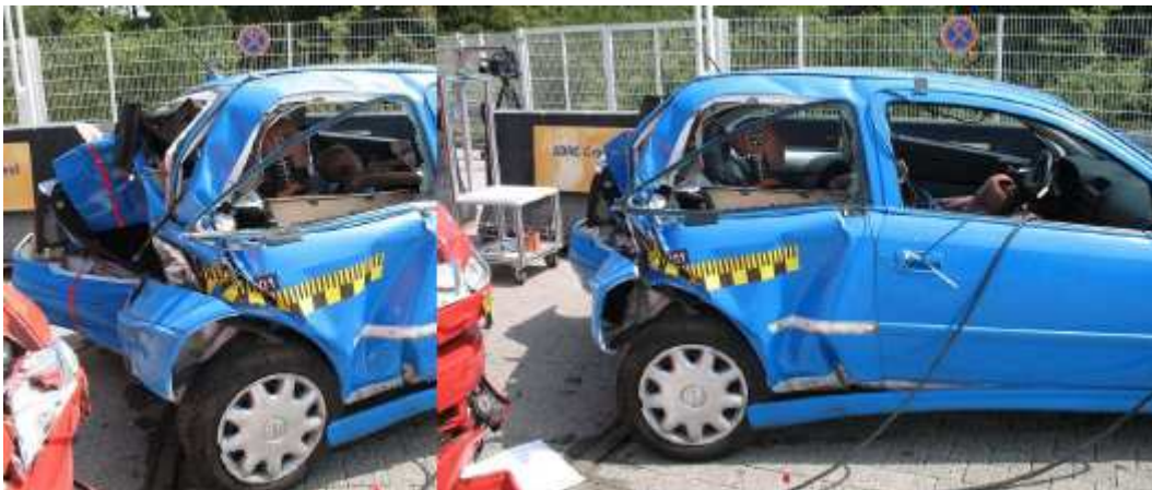
Prueba de choque por alcance: 60 Km./h
