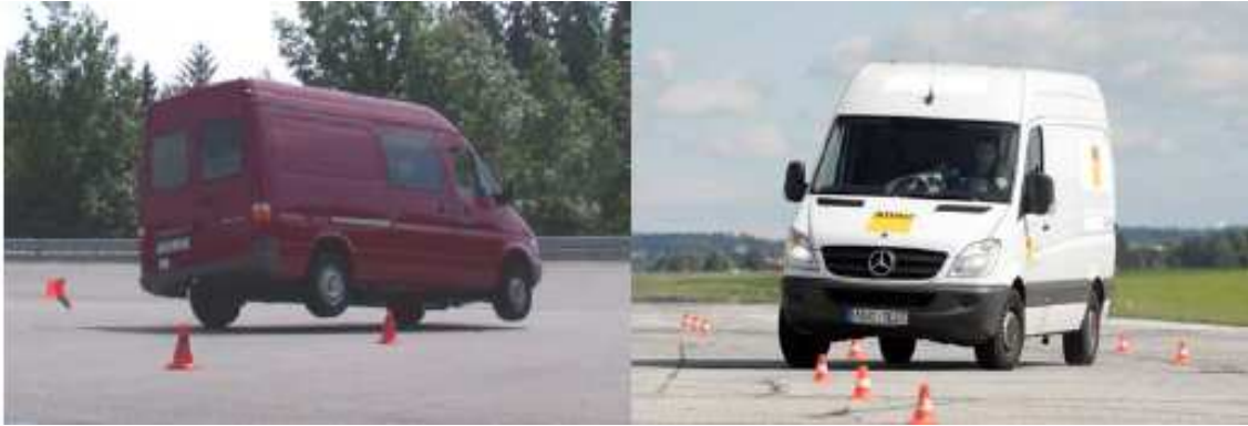
Prueba a 54 Km./h: sin y con ESP
