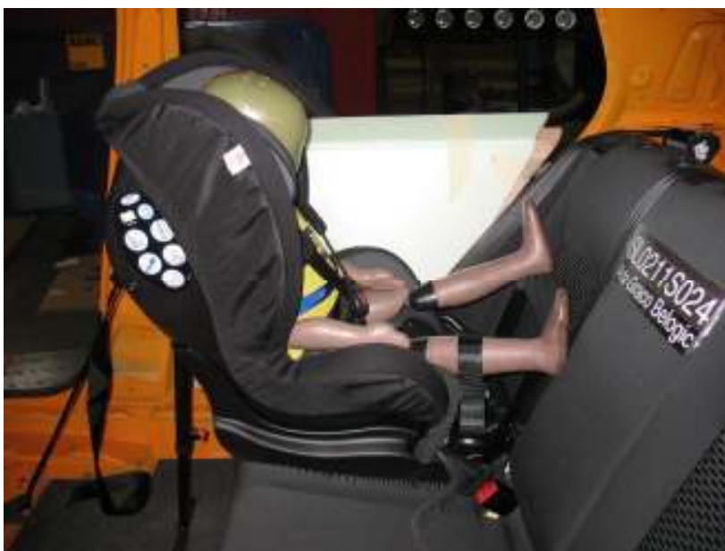
Figura 4: Akta Graco Belogic instalada en la carrocería del vehículo.
