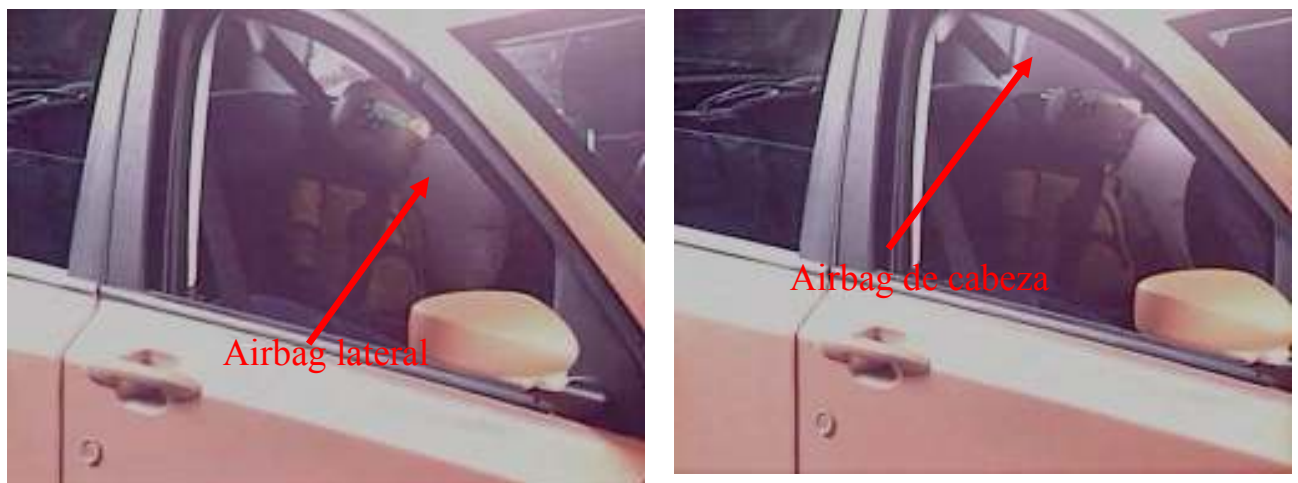
Figura 3: SRI sin respaldo en un ensayo utilizando un vehículo con airbag lateral y airbag de cabeza.
