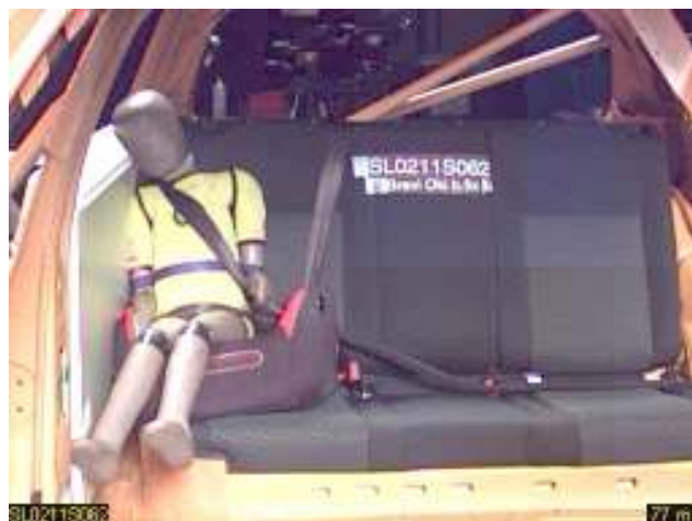
Figura 2: Ejemplo de cojín elevador sin respaldo: la cabeza del maniquí está desprotegida absolutamente y se golpea fuertemente contra las puertas del coche.
